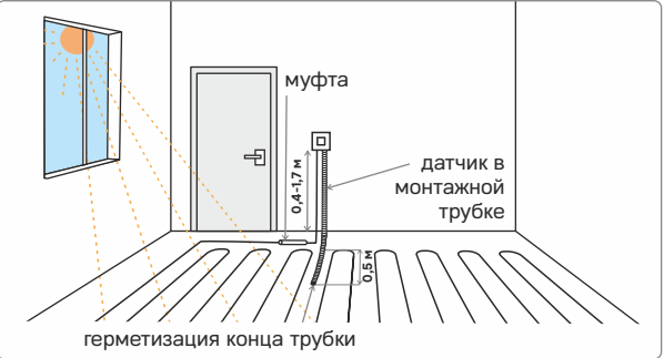
Рисунок 1. Монтаж терморегулятора и теплого пола
